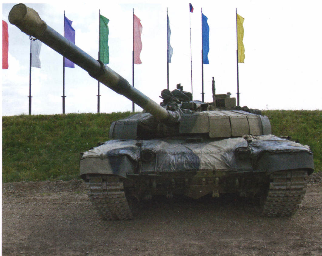
Т-72Б2 («объект 184М»), вид спереди. Хорошо виден маскировочный комплект «Накидка» для защиты от обнаружения в инфракрасном диапазоне.
