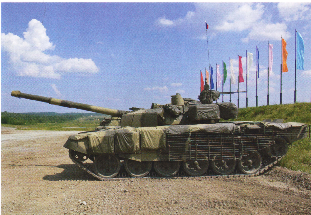
Т-72Б2, разработанный по ОКР «Рогатка-1». Обратите внимание на решетчатые противоккумулятивные экраны на бортах.
